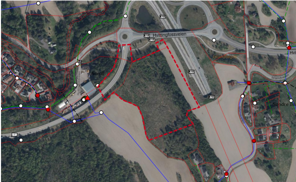
Figur 9: Planområdet ift. spillvannsledning (grønn), vannledning (blå) og overvannsledning (svart)
