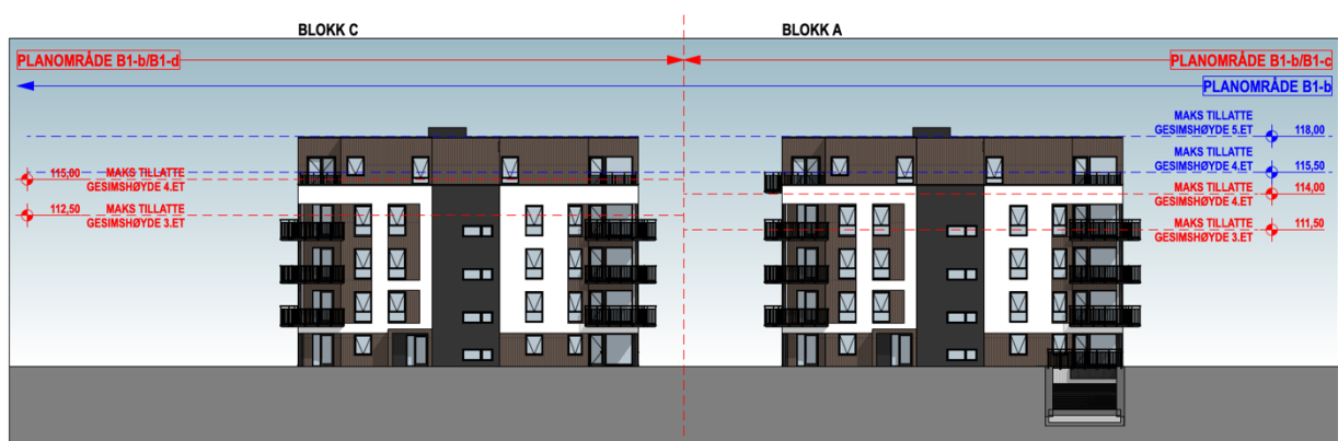
Figur 5: Fasade øst blokk A og C (rød tekst viser gjeldende regulering og blå tekst viser ønsket endring)
