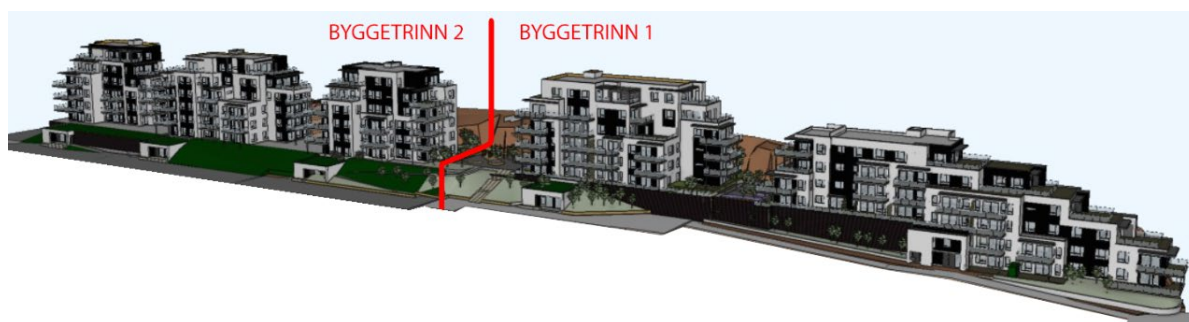
Figur 8 Bildet viser hvordan byggetrinnene skal deles inn.
