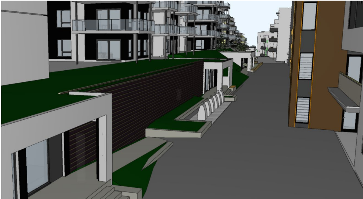
Figur 20 Eksempel på inngangsparti med sykkelparkering. Areal til boder er lagt tilbaketrasket mellom inngangspartiene med rampe og beplantning i forkant. Løsningen er tilpasset eksisterende renovasjons-stasjon. (Perspektiv fra nordvest)
