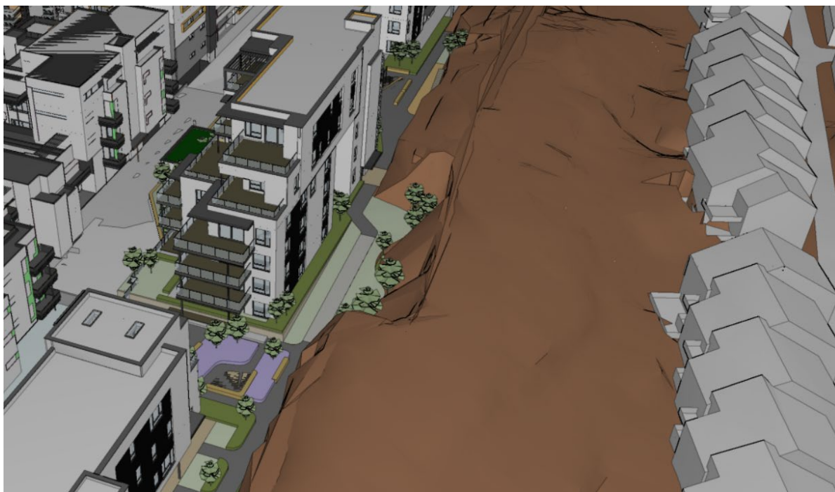
Figur 14 Illustrasjon av bearbeidet fjellnisje. Området må opparbeides for å unngå hull i bakken. (Perspektiv fra sydøst)
