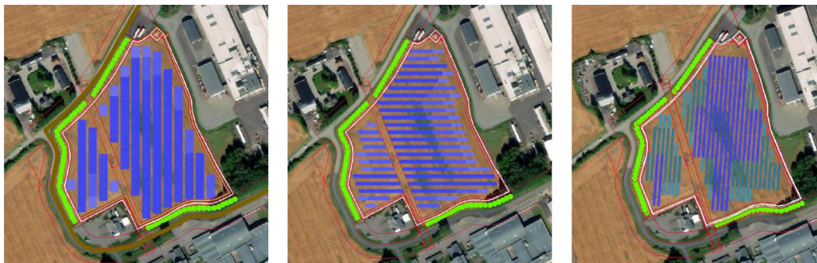
Figur 11 Forslag til tre ulike layoutalternativer for bakkeanlegget på gbnr.: 64/3. Kilde: Multiconsults mulighetsstudie
