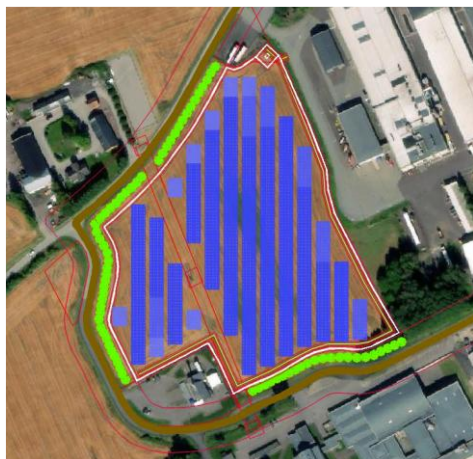
Figur 17 Eksempel på mulig layoutløsning: Solcelleanlegget legges med solcellerader som her i eksempelvis nord-sør-retning som hensyntar høyspentlinjen over dagens jorde. I denne layouten henvender solcellepanelene seg halvparten mot øst og andre halvpart mot vest. Fundamenteringsmuligheter som betong eller jordskruer benyttes til å feste panel i grunnen. Kilde: Multiconsults mulighetsstudie Kilde: Multiconsults mulighetsstudie.
